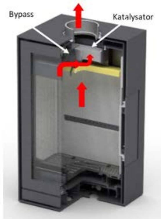
Abb. 10. Rauchgaszirkulation bei geschlossenem Bypass
